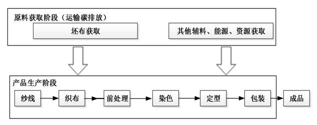
图 2.2.1 棉氨布产品生命周期 (LCA)系统边界图
