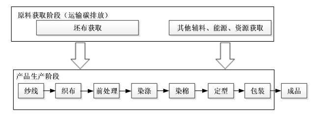
图 2.2.2 棉涤布产品生命周期 (LCA)系统边界图
